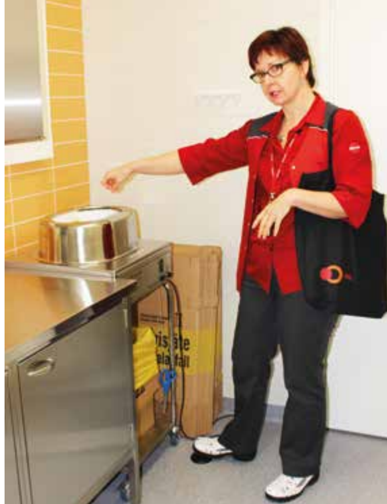
>> Pactosafe-jätteenpakkaaja pakkaa ilmatiiviisti sytostaattihoidoista tulevat jätteet.
