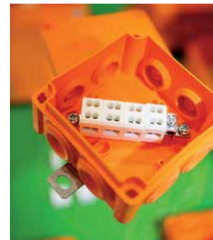
PYRO Hotfix -palojakorasioissa osat ovat valmiiksi esikoottuna, mikä helpottaa sähköasentajan työtä. Haaroitusliittimet ovat kahdella tai neljällä johdinaukolla, TET-läpiviennit valmiiksi paikoillaan ja pikaruuvit kannen kiinnityksessä.
