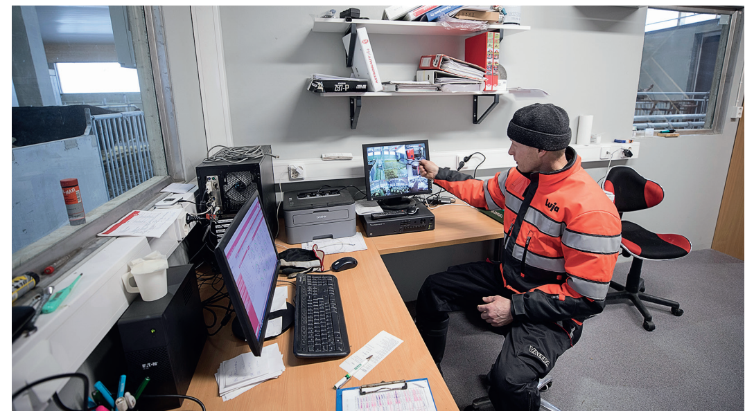
Isäntä Markku Räsänen ”komentokeskus”. Räsänen voi seurata navetan tapahtumia myös sisällä talossa valokuituyhteyden kautta. Kameeroita on kuusi eri puolella navettaa. Niiden sijoittelua jouduttiin muuttamaan, koska langattoman yhteyden sijasta jouduttiin turvautumaan valokuituun. Langaton signaali ei tunkeutunut betonin läpi. Tietokoneet ja piirikortit on kytketty online-UPS-sähköön.
