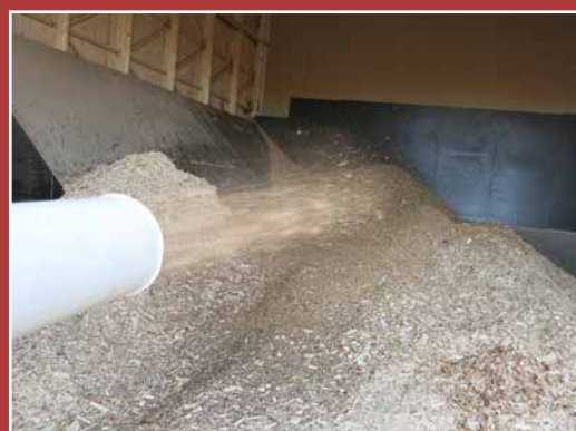
Hake puhalletaan pneumaattisesti hakekonttiin
